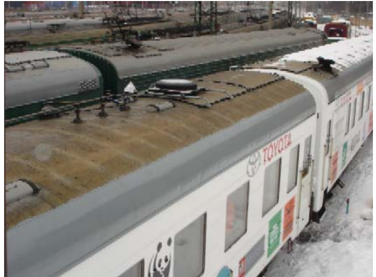
Вид сверху на вагон. Антенны ГлобалСтар и ТракВижн А5.
